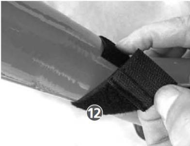
Klettband (12) als Lackschutz am Unterrohr
