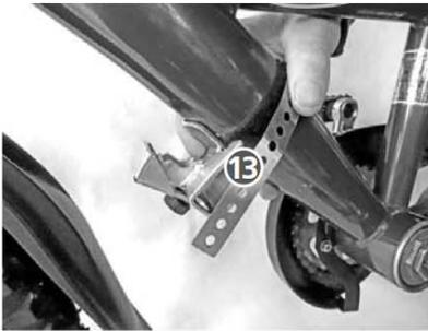
Klammer mit Lochband (13) an das Rohr
