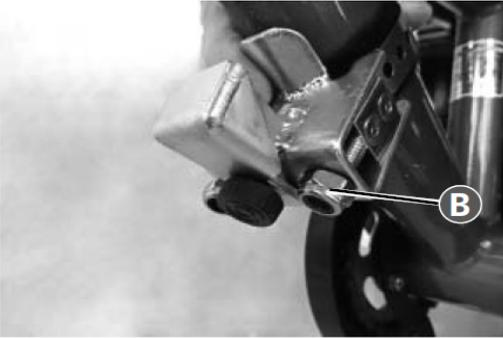
Sechskantmutter (B) nur leicht festziehen – die Klammer muss später noch auf dem Rohr justiert (verschoben) werden.
