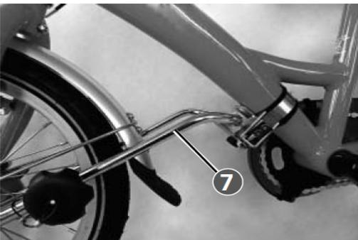
Für diesen Fall kann der *Teleskopbügel* (7) um 180° gedreht montiert werden. Ziel ist in jedem Fall eine Bodenfreiheit des Kinderforderrades von 6-8 cm zu erreichen. Siehe auch Kapitel 8.2.
