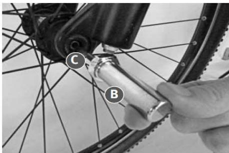
Steckachse (C) durchschieben und beide Achsverlängerung (B) anschrauben und festziehen (Drehmoment 7-8 Nm). Danach muss das Laufrad mittig stehen. D.h. dass der Abstand zwischen Felge und Rahmen auf beiden Seiten gleich ist.
