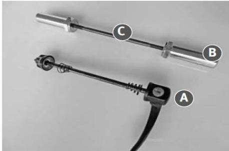
Schnellspanner (A) wird gegen Achsverlängerung (B) mit Steckachse (C) ausgetauscht. Achsverlängerung (B) und Steckachse (C) gehören nicht zum Standard-Lieferprogramm. Siehe auch Kap. 10, Zubehör und Ersatzteile.
