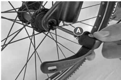
Zuerst Schnellspanner (A) komplett entfernen. Ausfallsicherungen beidseitig in den vorgesehenen Öffnungen stecken lassen.
