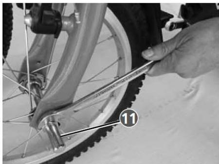
Festziehen (Drehmomentangabe des Fahrradherstellers einhalten). Danach muss das Laufrad mittig stehen. D.h. dass der Abstand zwischen Felge und Gabelrohr auf beiden Seiten gleich ist. Die Achsverlängerungen (11) übernehmen auch die Funktion der Radmutter. Prüfen sie daher regelmässig den festen Sitz der Achsverlängerungen, am Besten vor jeder Fahrt.
