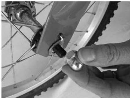
Radmuttern lösen und entfernen. Beilag-, bzw. Unterlagscheibe auf der Achse lassen.
