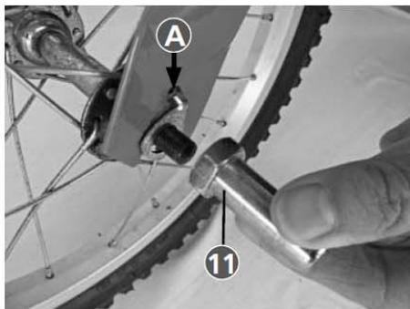
Achsverlängerungen (11) anschrauben. Achten Sie darauf, dass die Ausfallsicherung (A) in die vorgesehene Öffnung greift.
