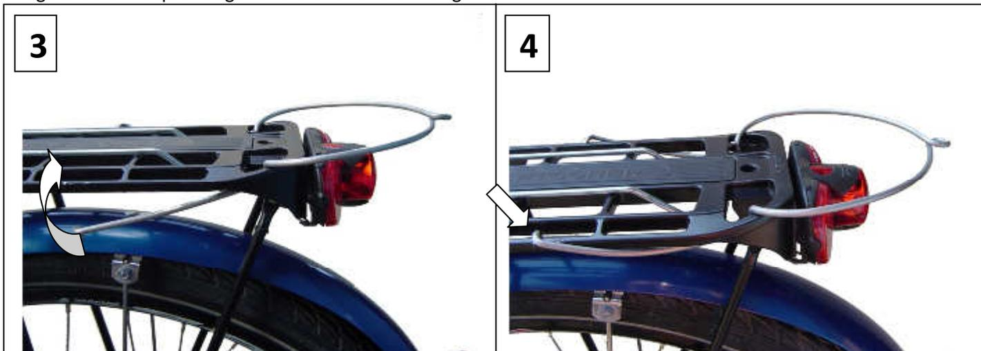
Falls erforderlich mit Kabelbinder sichern und FollowMe mittels Karbinerhaken aufhängen:
