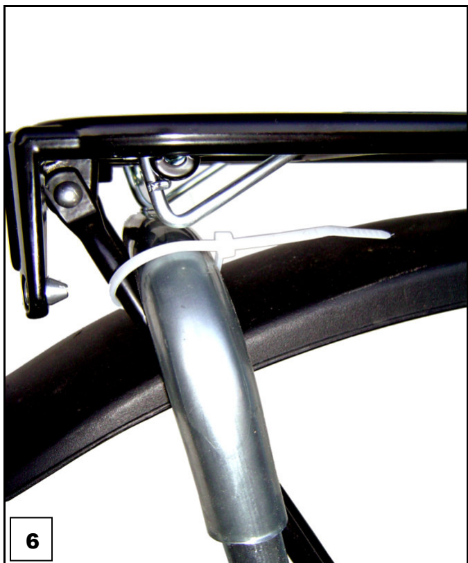
6. Mit Kabelbinder U-Rohr an Gepäckträger- Strebe fixieren. Schritt 2 bis 6 auf der linken Fahrradseite durchführen.
